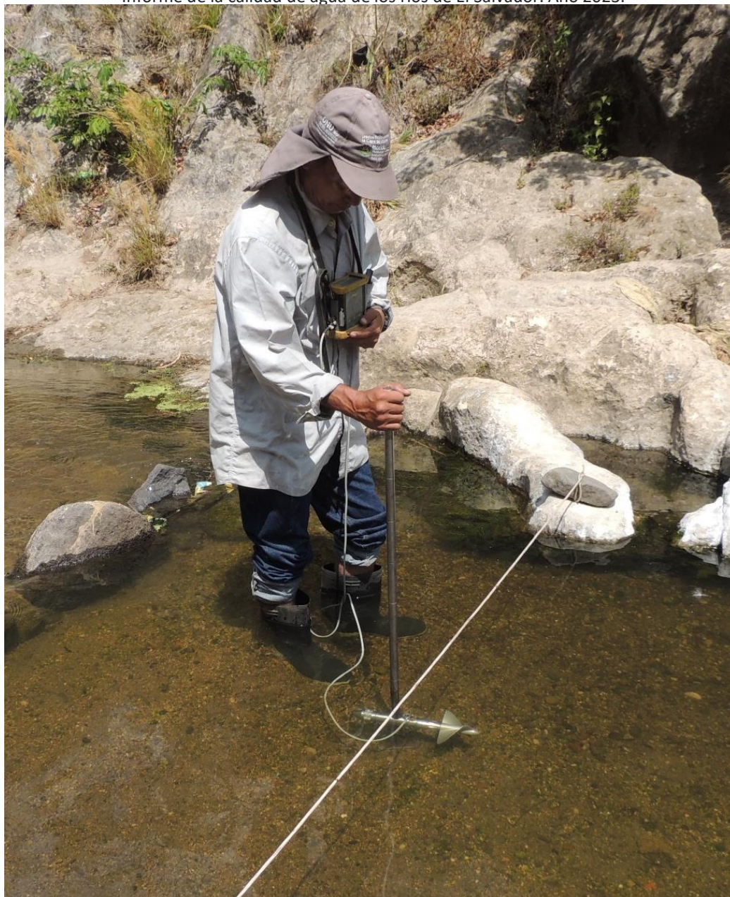
Figura 2. Medición de la velocidad de la sección parcial por unidad de tiempo.
